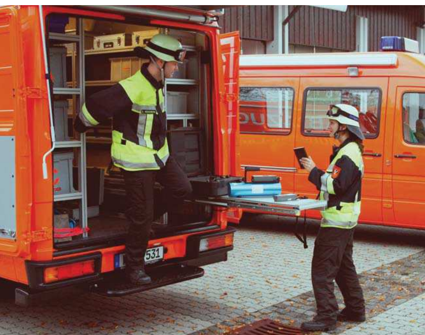
Mit dem Arbeitstisch am Heck ist eine geregelte Ausgabe der Messgeräte möglich.
