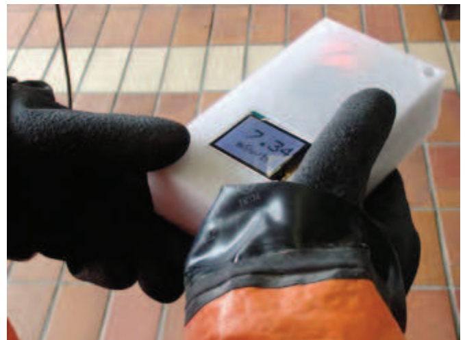
Anzeige der Dosisleistung auf dem Display. (Fotos, Abbildungen: ABC-Zug München-Land)
